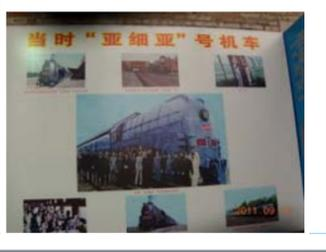
旧満州を駆け抜けた特急「あじあ」1934年川崎重工製造 現存2両。機関車総重量215ト、動輪3 直径2m。大連―新京(長春) 700Kを7時間半で疾走。
